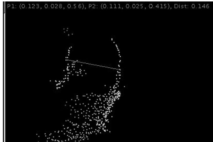
Abbildung 3.10: Orientierte Punkte eines Korbs nach umgebungsbezogener Filterung und Vermessung des Henkeldurchmessers.
